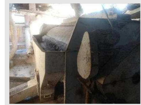
ENGROSSADOR MARCA THECNOPULP DIM 120X300 CM MOTOR DE 3 CV | Item: 94 |
