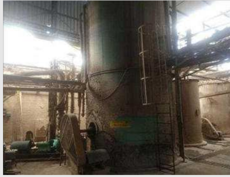
TANQUE CILÍNDRICO EM AÇO CARBONO (MISTURA) COM AGITADOR 30 CV DIAM 300X500 CM E BOMBA CENTRÍFUGA MARCA IMBIL MOD 200/340 COM MOTOR DE 25 CV | Item: 57 |
