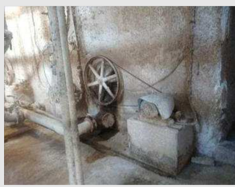
AGITADOR PARA TANQUE DE MASSA (ALVENARIA) COM MOTOR DE 10 CV | Item: 105 |
