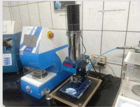
POROSÍMETRO MARCA MECATECNICA MOD PGD- 100 | Item: 156 |
