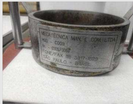
APARELHO DE TESTE DE ABSORÇÃO DE AGUA (COOB TEST) MARCA MECATECNICA MOD COOB VENDIDO PELA REGMED | Item: 161 |
