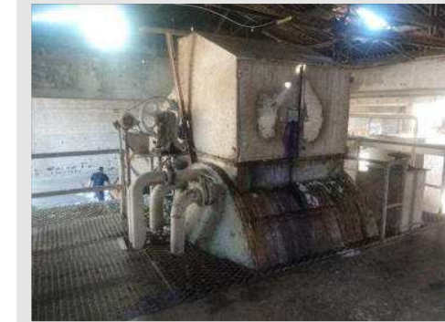
HYDRAPULPER HORIZONTAL EM AÇO INOX (CAPA) CAP 8M³ MOTOR 100CV | Item: 85 |
