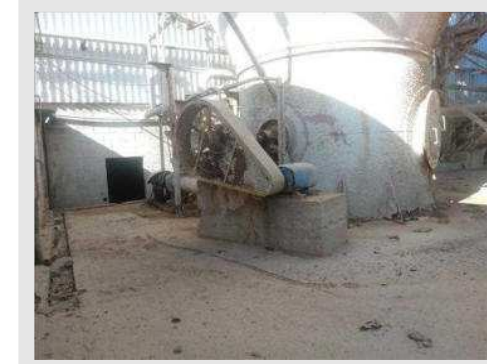
TANQUE CILÍNDRICO EM AÇO CARBONO (FIBRA LONGA) COM AGITADOR COM MOTOR DE 20 CV E BOMBA CENTRÍFUGA MARCA IMBIL MOD RAS 100/270 | Item: 20 |
