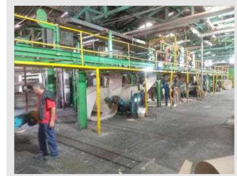
MÁQUINA PARA COLAR PAPEL TIPO ONDULADEIRA COM LARG. 2800MM E VEL. 60 M/MIN, 1 ROLO ESCRAVO E CORTADEIRA DE PAPEL C/ MESA SAIDA MARCA MARQUIP MOD IIIIL NS 71092 | Item: 130 |
