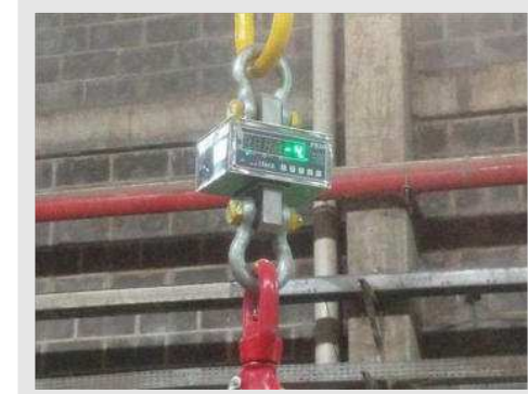
BALANÇA SUSPENSA DIGITAL MARCA LIDER PR30/10.000 CAP 10 TON | Item: 127 |
