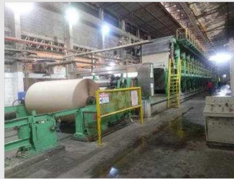
MAQUINA DE PRODUÇÃO DE PAPEL TIPO WTL E MIOLO COM VEL. DE 300 M/MIN E PRODUÇÃO DIÁRIA DE 120 TON | Item: 145 |
