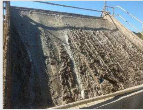
PENEIRA TIPO SIDE HILL DIM 1.30X2.70 MCO. TELA DE MALHA 16MM | Item: 32 |
