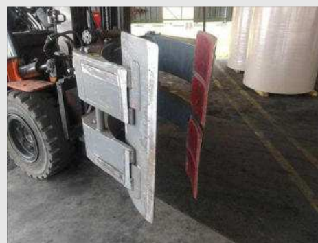
GARRA HIDRAULICA PARA BOBINA MARCA CASCA DE MOD 60G-RDP ( ACOPLADA A EMPILHADEIRA ) | Item: 265 |
