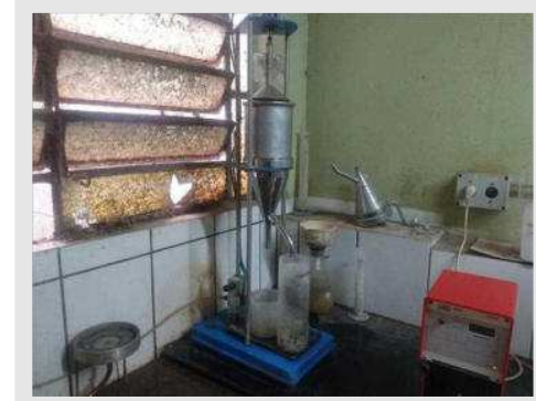
APARELHO SHOPPER RIEGLER PNEUMÁTICO (MEDE DRENAGEM DA FIBRA) MARCA MECATECNICA MOD SPR | Item: 163 |
