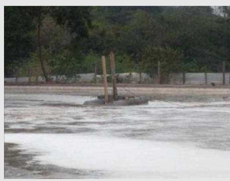
TURBO AERADOR OXIGENADOR MARCA HELIBOMBAS MOD HMO COM MOTOR DE 15CV | Item: 255 |
