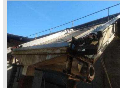
PENEIRA DE SEPARAÇÃO EM AÇO INOX DESAGUADORA DE LODO | Item: 38 |
