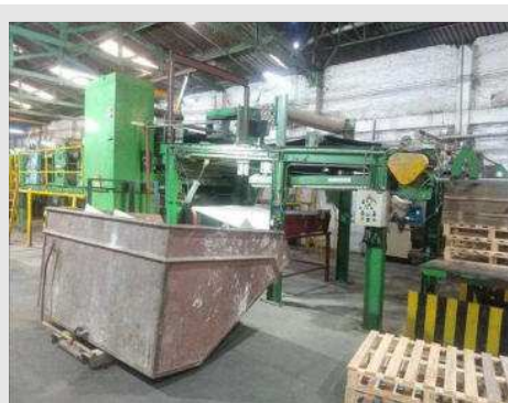
MÁQUINA PARA COLAR PAPEL TIPO ONDULADEIRA COM LARG. 2800MM E VEL. 60 M/MIN, 1 ROLO ESCRAVO E CORTADEIRA DE PAPEL C/ MESA SAIDA MARCA MARQUIP MOD IIII NS 71092 | Item: 130 |
