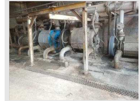
BOMBA DE VÁCUO MARCA NASCH MOD CL 4002 COM MOTOR DE 250 CV | Item: 116 |
