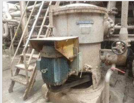
DEPURADOR VERTICAL MARCA VOITH MOD 21D MOTOR 60 CV | Item: 25 |
