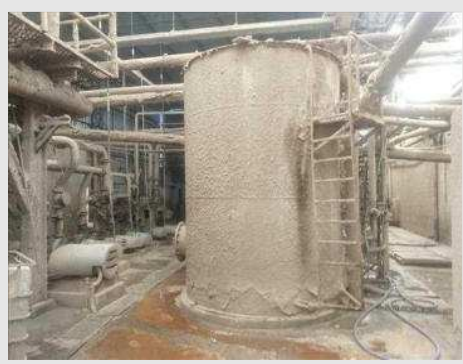
TANQUE CILÍNDRICO EM AÇO CARBONO (CAPA) COM AGITADOR DIM 250X350 CM E MOTOR DE 15 CV | Item: 50 |
