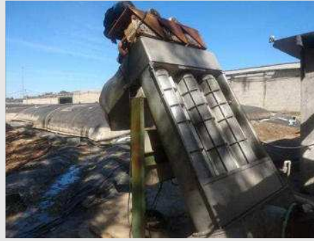
ROSCA DESAGUADORA DE LODO EM AÇO INOX COM 3 MOTOR E 3 REDUTOR | Item: 39 |
