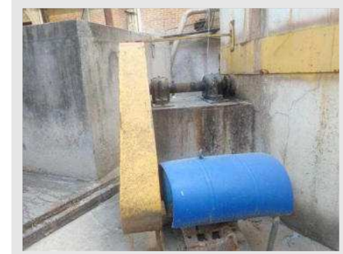
AGITADOR PARA TANQUE DE MASSA (ALVENARIA) COM MOTOR DE 10 CV | Item: 101 |
