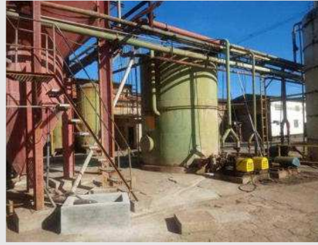
TANQUE CILÍNDRICO EM AÇO CARBONO ÁGUA PULMÃO (BRAVA) DIAM 250X350 CM | Item: 29 |
