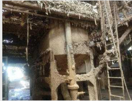
HYDRAPULPER (5) EM AÇO CARBONO REVESTIDO EM AÇO INOX COM CAP 26 M³ COM MOTOR DE 350 CV CONSISTENCIA DE ATE 5% VM COM ESTEIRA MARCA VOITH | Item: 41 |
