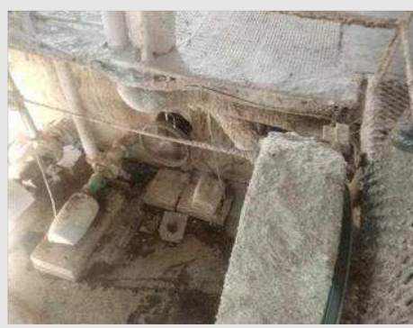
AGITADOR PARA TANQUE DE MASSA (ALVENARIA) COM MOTOR DE 10 CV | Item: 87 |
