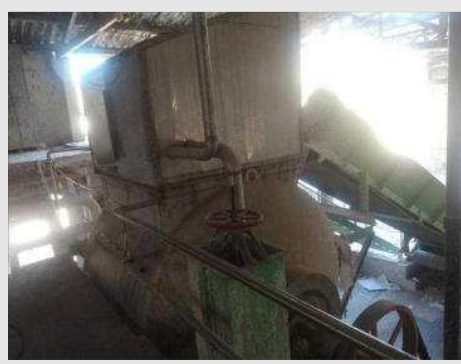
HYDRAPULPER HORIZONTAL EM AÇO INOX (CAPA) CAP 8M³ MOTOR 100CV | Item: 86 |
