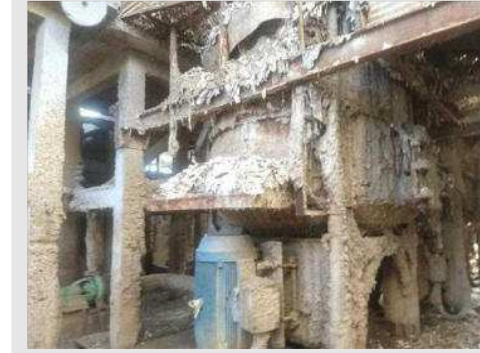
HYDRAPULPER (4) EM AÇO CARBONO REVESTIDO EM AÇO INOX COM CAP 26 M³ COM MOTOR DE 350 CV CONSISTENCIA DE ATE 5% VM COM ESTEIRA MARCA VOITH | Item: 40 |
