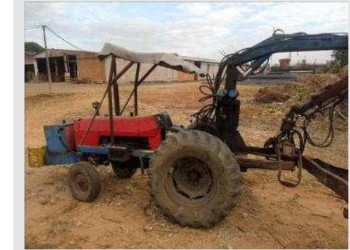
TRATOR MARCA MASSEY FERGUSON COM GUNDASTE GARRA PARA LENHA | Item: 250 |
