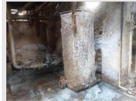
TANQUE CILÍNDRICO EM AÇO CARBONO (REJEITO CAPA) DIAM 180X200 CM COM BOMBA CENTRÍFUGA MARCA IMBIL COM MOTOR DE 10CV | Item: 77 |
