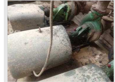
BOMBA CENTRÍFUGA EM AÇO INOX MARCA IMBIL MOD RAS 125/200 COM MOTOR DE 30 CV | Item: 49 |
