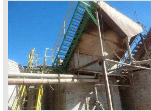
PENEIRA TIPO SIDE HILL DIM 1.30X2.70 MCO. TELA DE MALHA 16MM | Item: 32 |
