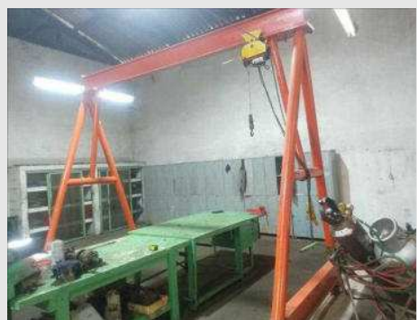
PÓRTICO MÓVEL COM TALHA CAP 600KG DIM 3,50X3,0 M | Item: 203 |
