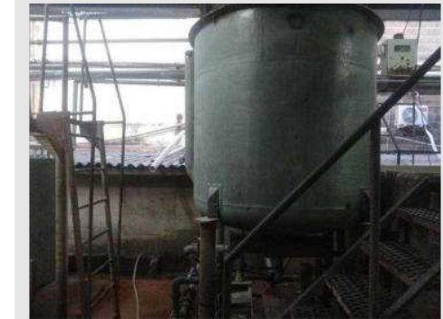
TANQUE CILÍNDRICO EM AÇO INOX COM AQUECIMENTO A VAPOR DIAM 150X200 CM COM BOMBA HELICOIDAL MARCA NETZCH MODELO NEMO NM031BY01L06B (AMIDO) | Item: 27 |
