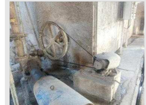
AGITADOR PARA TANQUE DE MASSA (ALVENARIA) COM MOTOR DE 10 CV | Item: 104 |
