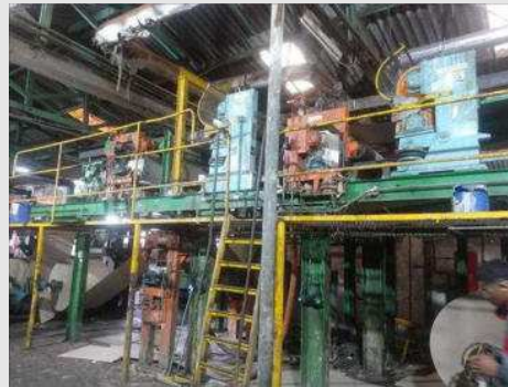
MÁQUINA PARA COLAR PAPEL TIPO ONDULADEIRA COM LARG. 2800MM E VEL. 60 M/MIN, 1 ROLO ESCRAVO E CORTADEIRA DE PAPEL C/ MESA SAIDA MARCA MARQUIP MOD IIIIL NS 71092 | Item: 130 |
