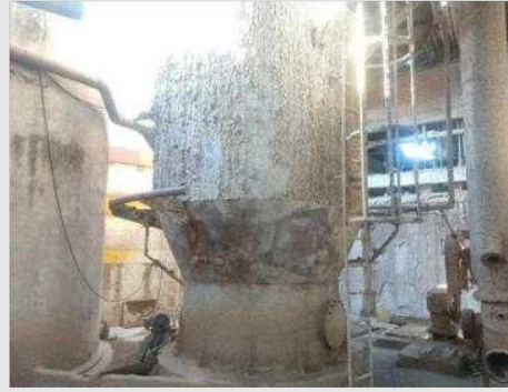
TANQUE CILÍNDRICO EM AÇO CARBONO MASSA (PULMÃO) DIAM 300X350 CM COM AGITADOR MOTOR 15 CV E BOMBA CENTRÍFUGA MARCA IMBIL MOD RAS 100/270 COM MOTOR DE 25 CV | Item: 100 |
