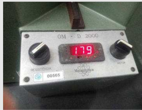
APARELHO PARA TESTE DE RESISTÊNCIA DA ONDA MARCA MECATECNICA MOD OM-D2000 | Item: 160 |
