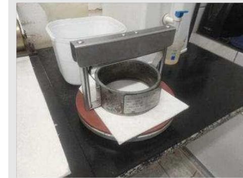
APARELHO DE TESTE DE ABSORÇÃO DE AGUA (COOB TEST) MARCA MECATECNICA MOD COOB VENDIDO PELA REGMED | Item: 161 |
