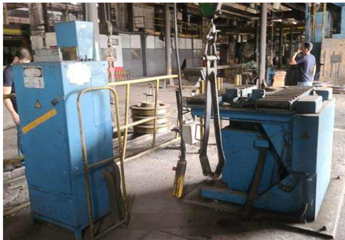
**DESCRIÇÃO: MÁQUINA DE BALANCEAMENTO**
