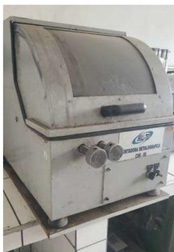
**DESCRIÇÃO: MÁQUINA CORTADORA METALOGRÁFICA****FABRICANTE: SKILL TECH****MODELO: CSK 10****ANO DE FABRICAÇÃO: 2008****ESTADO DE CONSERVAÇÃO: REGULAR****ÁREA LOCALIZAÇÃO: QUALIDADE**
