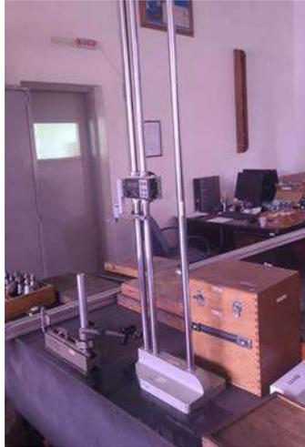
**DESCRIÇÃO: ALTÍMETRO DIGITAL**
