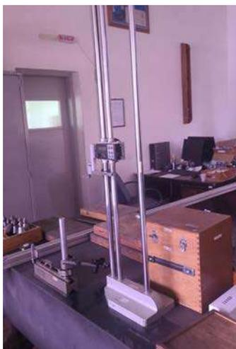
**DESCRIÇÃO: ALTÍMETRO DIGITAL**
