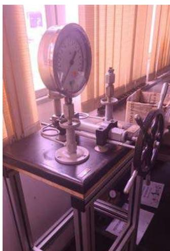
**DESCRIÇÃO: CALIBRADOR DE MANÔMETRO**
