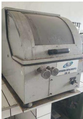
**DESCRIÇÃO: MÁQUINA CORTADORA METALOGRÁFICA**
