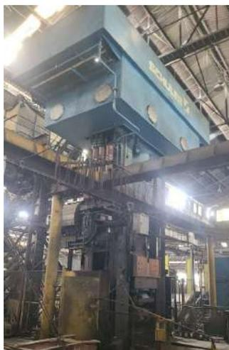
**DESCRIÇÃO: PRENSA HIDRÁULICA MH 3000**
