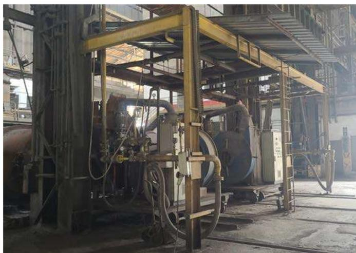
**DESCRIÇÃO: AQUECEDOR DE PANELA 01****FABRICANTE:****MODELO:****ANO DE FABRICAÇÃO: 1994****ESTADO DE CONSERVAÇÃO: REGULAR****ÁREA LOCALIZAÇÃO: ACIARIA**
