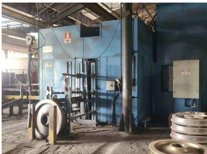
**DESCRIÇÃO: MÁQUINA DE INSPEÇÃO PARTÍCULAS MAGNÉTICAS****FABRICANTE: IMADEN****MODELO: UPE-5K-CC****ANO DE FABRICAÇÃO: 2004****ESTADO DE CONSERVAÇÃO: REGULAR****ÁREA LOCALIZAÇÃO: INSPEÇÃO DE RODAS**
