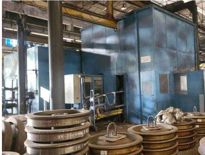
**DESCRIÇÃO: MÁQUINA INSPEÇÃO ULTRASOM**
