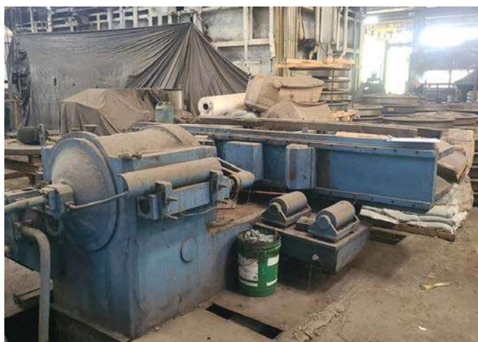
**DESCRIÇÃO: PRENSA DESEMPENADORA EIXOS****FABRICANTE: MORANE****MODELO:****ANO DE FABRICAÇÃO: 1958****ESTADO DE CONSERVAÇÃO: FORA DE USO****ÁREA LOCALIZAÇÃO: FORJAMENTO DE EIXOS**
