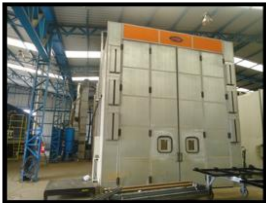
CAIXINES DE JATEAMENTO DE GRANALHA
