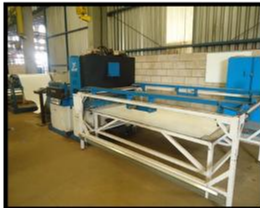
MAQUINA PARA CORRUGAR CAPA DE ALUMINIO
