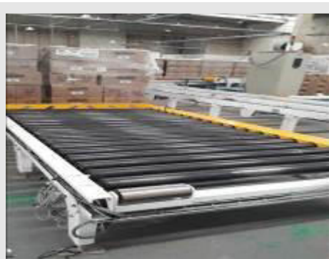
ESTEIRA DE ROLETES MOTORIZADO MARCA FABRIMA TIPO ENTRADADA DE PALET MOD. 5X06030000 NS. 20200342 PED. 625190 DIM. 1,10X2,40 M | Item: 52 |
