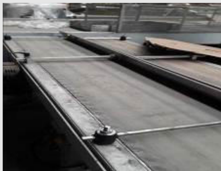
ESTEIRA TRANSPORTADORA DE LONA MOTORIZADA MARCA SMIPACK MOD. GH2000/600 NS. 31760 COD. MY340105 DIM. 0,60X2,0 M | Item: 273 |
