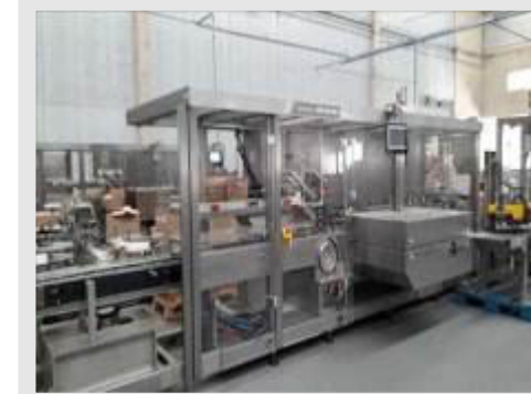
ENCARTUCHADORA MARCA FABRIMA TIPO HORIZONTAL MOD. CPF-10/100 NS. 20190083 PEDIDO 139049 CAP. 100/MIN. | Item: 54 |
