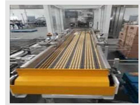
ESTEIRA ACUMULADORA MARCA FABRIMA TIPO ACUMULADORA PARA PICK MOD. 70001M0000 DIM. 0,40X3,0 M | Item: 60 |
