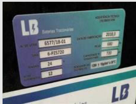
BATERIA TRACIONARIA MARCA LB BATERIAS TIPO 6-PZS720 NS. 6577/18-01 CAP. 720AH/24V 12 ELEMENTOS | Item: 14 |
