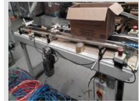
ESTEIRA TRANSPORTADORA DE LONA MOTORIZADA MARCA SMIPACK MOD. GH2000/400 NS. 58073 COD. MY340190 DIM. 0,40X2,0 M | Item: 248 |
