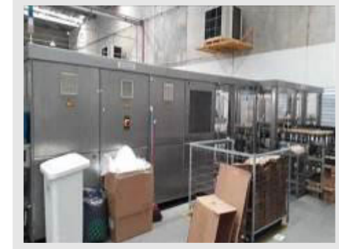
ENCARTUCHADORA MARCA FABRIMA TIPO HORIZONTAL MOD. CPF-10/100 NS. 20190068 PEDIDO 139047 CAP. 100/MIN. | Item: 33 |
