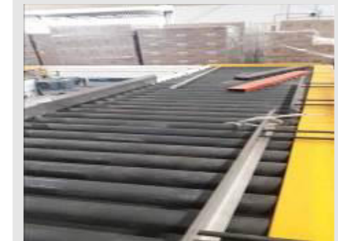
ESTEIRA DE ROLETES MOTORIZADO MARCA FABRIMA TIPO SAIDA DE PALET MOD. 5X11030000 NS. 20200342 PED. 625185 DIM. 1,10X1,70 M | Item: 17 |
