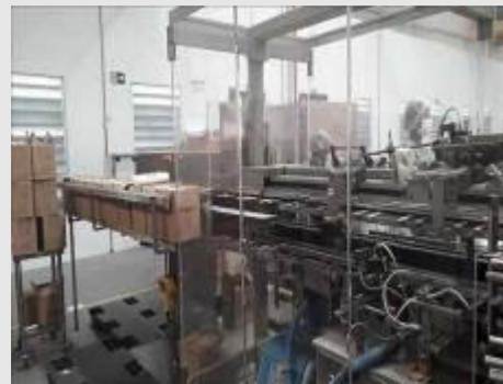
ENCARTUCHADORA MARCA FABRIMA TIPO VERTICAL MOD. VPF8-120 NS. 20140094 PED. 118809 CAP. 120 PCM | Item: 94 |
