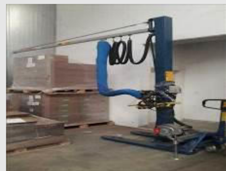
MANIPULADOR A VACUO C/ PALETEIRA HIDRAULICA E VENTOSA MARCA MONTAR BRAZILB TAWI TIPO SA 320/2 N. 12050 CAP. 40 KG | Item: 203 |
