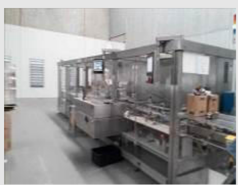
ENCARTUCHADORA MARCA FABRIMA TIPO HORIZONTAL MOD. CPF-10/100 NS. 20190068 PEDIDO 139047 CAP. 100/MIN. | Item: 33 |
