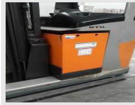
BATERIA TRACIONARIA MARCA LB BATERIAS TIPO 6-PZS720 NS. 6577/18-02;CAP. 720AH/24V 12 ELEMENTOS | Item: 26 |
