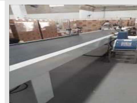
ESTEIRA TRANSPORTADORA DE LONA MOTORIZADA SEM MARCA APARENTE DIM. 0,60X6,0 M | Item: 143 |
