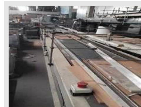
ESTEIRA TRANSPORTADORA EM LONA MOTORIZADA MARCA DAL MAK MOD. 500X6000 NS. 2445 DIM. 0,50X6,0 M | Item: 226 |
