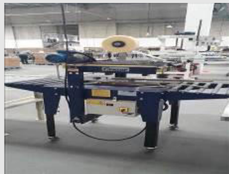
FECHADORA DE CAIXAS MARCA CYKLOP MOD. CT3A NS. 1909006 TIPO FECHAMENTO C/ FITA ADESIVA | Item: 74 |
