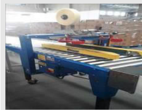
FECHADORA DE CAIXAS MARCA CYKLOP MOD. CT3IL NS. 1906039; TIPO FECHAMENTO C/ FITA ADESIVA | Item: 119 |
