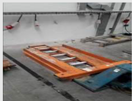
TRANSPORTADOR DE ROLETES LIVRES P/ TROCA DE BATERIA TRACIONARIA DIM. 0,50X1,0 M | Item: 10 |
