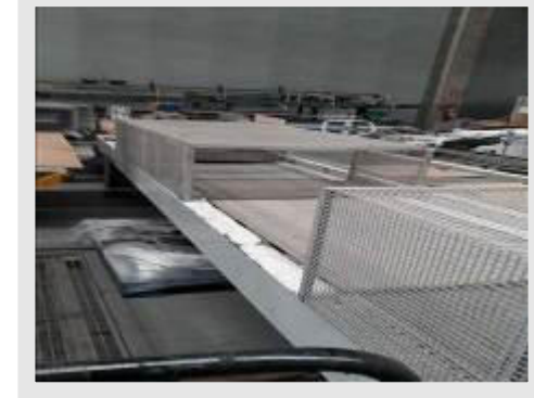
ESTEIRA TRANSPORTADORA EM LONA MOTORIZADA C/ PROTECAO TIPO GAIOLA DIM. 0,60X7,0 M | Item: 271 |
