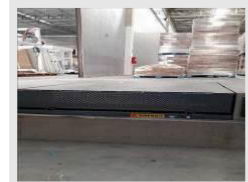
DOCA NIVELADORA HIDRÁULICA MARCA KOPRON MOD. KRA 1.200.245.550 NS. 585 CAP. 6000KG DIM. 2,0X2,20 M | Item: 32 |
