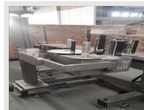
ROTULADORA CONTINUA MARCA QUADREL LABELING SYSTEM MOD. Q55 C/ ESTEIRA TRANSPORTADORA DIM. 0,40X3,0 M | Item: 137 |
