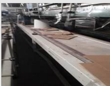
ESTEIRA TRANSPORTADORA EM LONA MOTORIZADA MARCA DAL MAK MOD. 500X6000 NS. 2445 DIM. 0,50X6,0 M | Item: 228 |
