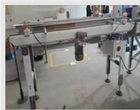
ESTEIRA TRANSPORTADORA DE LONA MOTORIZADA MARCA SMIPACK MOD. GH2000/400 NS. 59879 COD. MY3400190 DIM. 0,40X2,0 M | Item: 198 |
