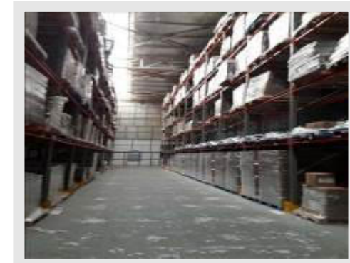
ESTANTE PORTA PALLET C/ 13 MODULOS C/ 5 NÍVEIS TOTAL DE 13X12 POSIÇÕES | Item: 28 |
