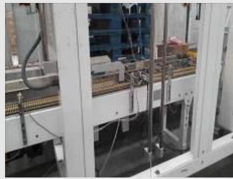
ESTEIRA ACUMULADORA MARCA FABRIMA TIPO ACUMULADORA PARA PICK MOD. 70001M0000 NS. 20200339 PED. 625185 DIM. 0,40X3,0 M | Item: 47 |
